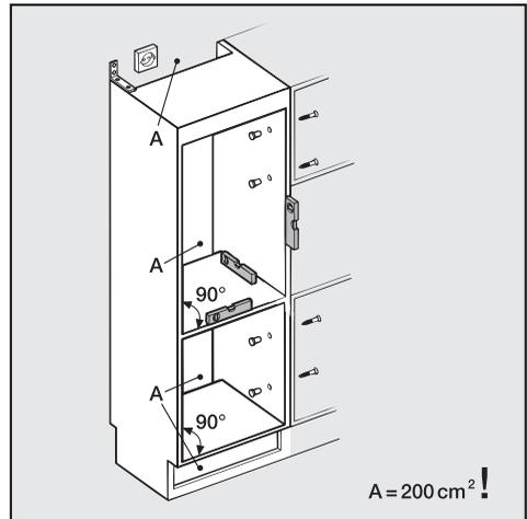
Vor Einbau des Gerätes den Einbauschränk sorgfältig mit einer Wasserwaage ausrichten. Die Schrankecken müssen im 90°-Winkel zueinander stehen, da sonst die Möbeltür nicht an allen 4 Ecken des Schrankes anliegen wird.
