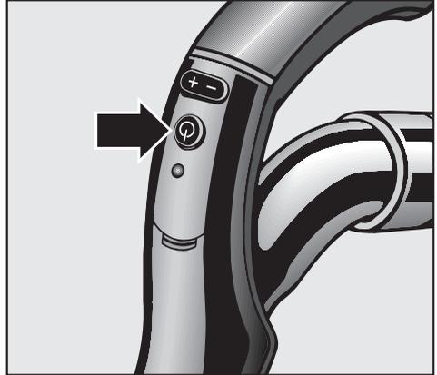
Bei der Erstinbetriebnahme schaltet sich der Staubsauger in der Leistungsstufe "Auto" ein.
