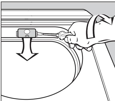
Die Glühlampe darf nur vom gleichen Typ sein und die maximale Leistung haben, die auf dem Typenschild und der Abdeckung für die Beleuchtung angegeben ist.
