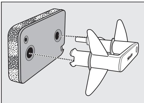
Nur der ordnungsgemäß eingesetzte Filter und die geschlossene Montageklappe gewährleisten die Dichtigkeit des Kondenssystems und eine einwandfreie Funktion des Trockners!
