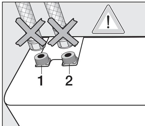
⚠ Bei Anschluss an einen Pufferspeicher müssen Anschlüsse **1+2** am Enthitzungsmodul dauerhaft mit Blindstopfen verschlossen werden. Es erfolgt nur eine interne Kühlung.
