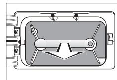
Der Feinfilter ist unten links, hinter der Klappe. Er fängt feinere Flusen, Haare und Waschmittelrückstände auf, die die Siebflächen der Flusensiebe durchdringen können.
