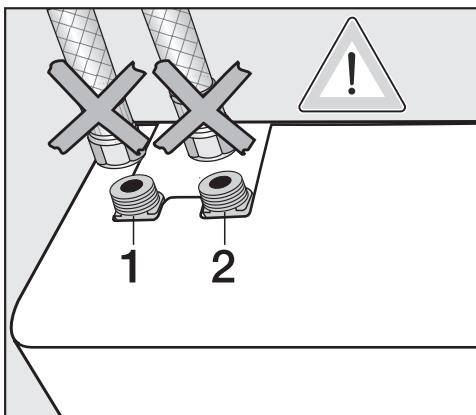
⚠ Bei Anschluss an einen Pufferspeicher (ausschließlicher Betrieb mit heißem Heizungswasser ohne Kaltwasserschicht) müssen Anschlüsse **1+2** dauerhaft mit Blindstopfen verschlossen werden. Es erfolgt nur eine interne Kühlung.
