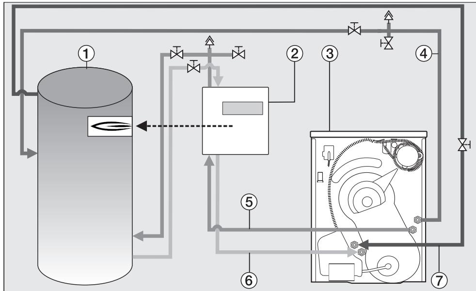
Der bauseits vorhandene Puffer- oder Schichtenspeicher wird über hydraulische Leitungen mit dem Miele Trockner und Enthitzungsmodul verbunden. Zusätzlich sind Absperrhähne, Rückschlagklappen und Entlüftungsventile vorzusehen.
