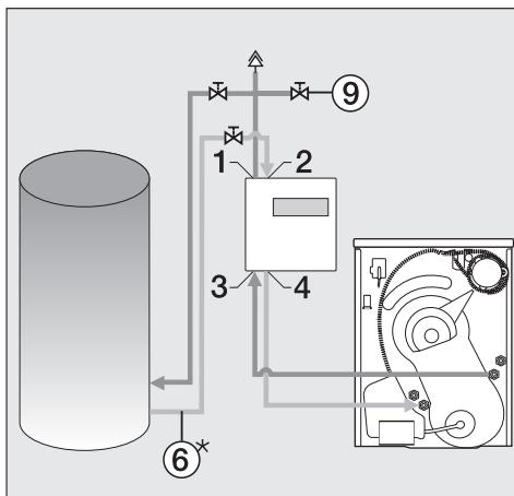
Bei Anschluss an einem Pufferspeicher müssen nach der Systembefüllung die Anschlüsse **1+2** am Enthitzungsmodul verschlossen werden.
