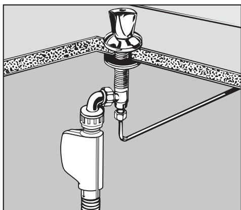
Für den Anschluss an ein Absperrventil in der Arbeitsplatte ist ein Winkel mit Überwurfmutter lieferbar (M.-Nr. 04 274 820).
