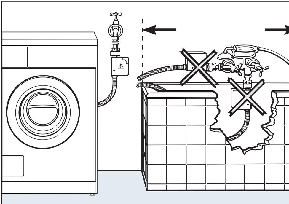
Das Sicherheitsventil enthält elektrische Bauteile. Deshalb darf es **nicht** in einem Spritzwasserbereich, z.B. Badewannen oder Duschen, montiert werden.
