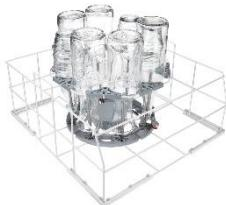
**Foto 1:** Acht Glasflaschen bis zu einer Höhe von 37,5 Zentimetern haben in dem neuen Miele-Korb einen sicheren Stand. Er kann schnell und einfach in Tankuntertischspüler eingesetzt werden und ist mit Injektordüsen ausgestattet, die eine zuverlässige Innenreinigung ermöglichen. (Foto: Miele)
