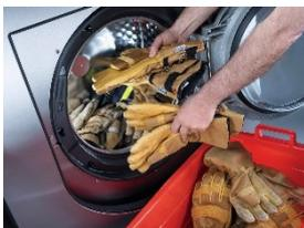
**Foto 3:** Handschuhe, die beim Einsatz vor Flammen schützen, werden durch eine Vorwäsche, vier weitere Waschgänge und bei 40 °C sauber. (Foto: Miele)
