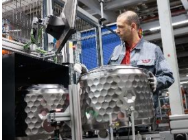
Foto 6: Ein Miele-Mitarbeiter prüft die „InfinityCare“-Waschtrommel, die weltweit erste rippenlose Trommel. (Foto: Miele)
