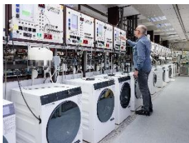
Foto 2: Dauertests im Labor: Miele testet Gerätemodelle auf eine Lebensdauer von bis zu 20 Jahren. (Foto: Miele)
