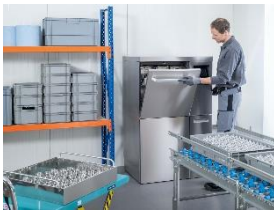
Foto 1: Kompaktes Reinigungsgerät von Miele, auch für anspruchsvolle Aufgaben in der industriellen Teilereinigung: das nur 90 Zentimeter breite Modell PLW 8636 IPC. (Foto: Miele)
