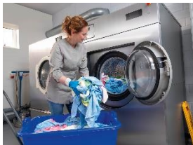
Foto 1: Viel Platz in der Trommel: Eine Waschmaschine für 35 Kilogramm Füllgewicht bietet Platz für bis zu 1.100 Wischtücher à 16 Gramm. (Foto: Miele)
