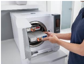
Foto 4: Zeitersparnis bei der Sterilisation: Trays werden komplett in Sterilcontainer gelegt und das Versiegeln einzelner Instrumente entfällt. Dadurch sinken die Kosten für Einwegverpackungen um mehr als 40 Prozent. (Foto: Miele)
