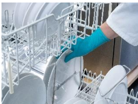
Foto 3: Prüfkörper aus Edelstahl, die zuvor mit Bakterien „angeschmutzt“ wurden, befestigt Diana Klapper mit speziellen Haltern an Tellern. Bei fünf unabhängigen Spülversuchen wird das mikrobiologische Ergebnis ermittelt und im Anschluss ein Mittelwert bestimmt. (Foto: Miele)
