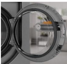
Foto 1: Herzstück des neuen Waschverfahrens PowerWash PRO: eine Düse im Tür-Schauglas. Mit Hilfe einer Umwälzpumpe wird die Waschlauge von hier aus schnell und effizient in den Textilien verteilt. (Foto: Miele)
