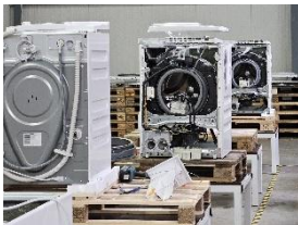
Foto 1: Kreislaufwirtschaft im Praxistest: Mehr als 2.000 zurückgeführte Waschmaschinen wurden im Projekt „2ndLife@Laundry“ bei Miele zerlegt und auf wiederverwendbare Komponenten untersucht. (Foto: Miele)
