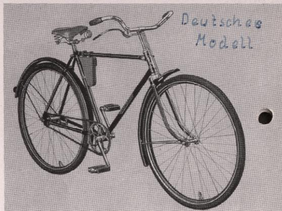
2 mm, rostsicher verchromt. **Tretlager:** Rechte Kurbel und Kettenrad mit Simplex-Befestigung. **Freilaufnabe:** Komet. **Vorderradnabe:** Miele mit Filzdichtung. **Lenker:** Neudeutsche Form. Handhebel-Vorderrad-**Bremse.** Hammock-Leder-**Sattel.** Kräftige Block-**Pedale.** **Zubehör:** Rahmentasche mit reichlichem Werkzeug. Rückstrahler.
