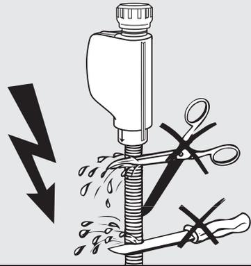
⚠ Stromschlaggefahr durch Netzspannung.
