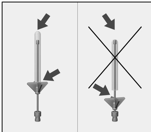
如果注射器喷嘴端碰到玻璃器皿底部，则需将塑料支架向上推。
