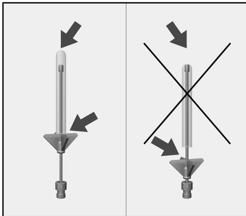
Jos suuttimen kärki ottaa kiinni lasin pohjaan, työnnä muovitukia ylöspäin.
