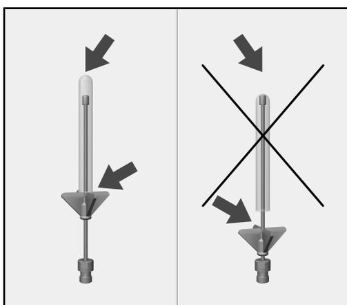
Если конец сопла упирается в дно посуды, то следует сдвинуть вверх пластмассовую опору.
