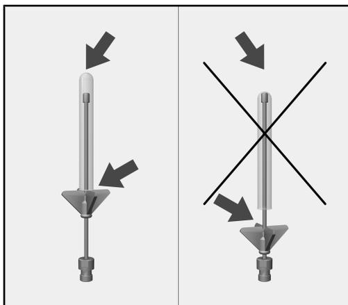
インジェクターノズルの先端がガラス製品の底部に当たる場合は、プラスチック製のサポートを押し上げる必要があります。
