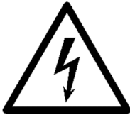
Achtung: Gefahr durch elektrischen Schlag
